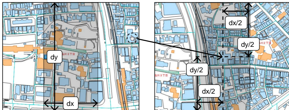
図 3-5：指定した位置を中心に地図を表示する座標値の求め方
